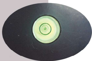
Livella per la messa in bolla dello strumento
